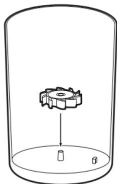
Propellern passar bara åt ett håll, så prova att snurra den. Den bör rotera lätt.
